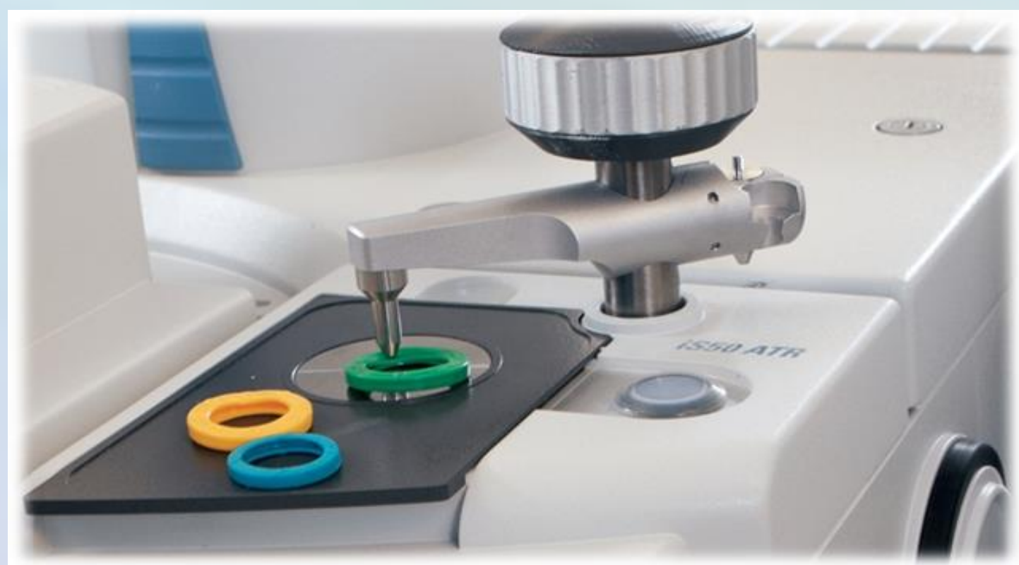
FTIR spektrometr Nicolet iS50 a detail jeho ATR modulu
