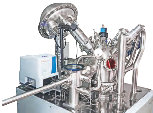
Obr. 4 – Kombinace Ramanova spektrometru iXR a ThetaProbe AR-XPS
